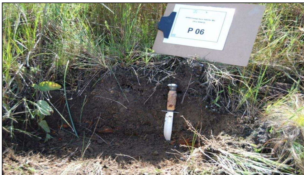
FIGURA 17 – Perfil de Solo Representativo do Ambiente – Neossolo Litólico Distrófico típico (RLd)
