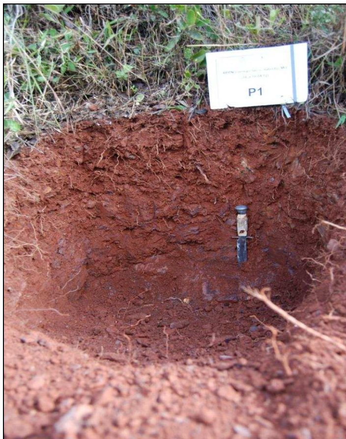
FIGURA 23 – Perfil de CAMBISSOLO HÁPLICO Tb Distrófico Amostrado no Geoambiente Encostas Dissecadas com Cerrado Stricto Sensu e Campo Cerrado Sobre Xistos e Gnaisse
