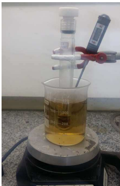
Figura 4: Sistema utilizado para a etanolise do óleo da macaúba.
