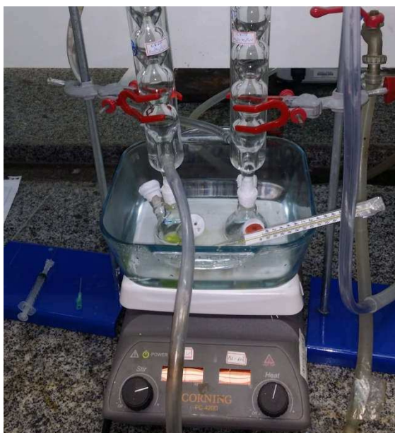
Figura 10: Sistema utilizado nas reações de esterificação do ácido levulínico.
