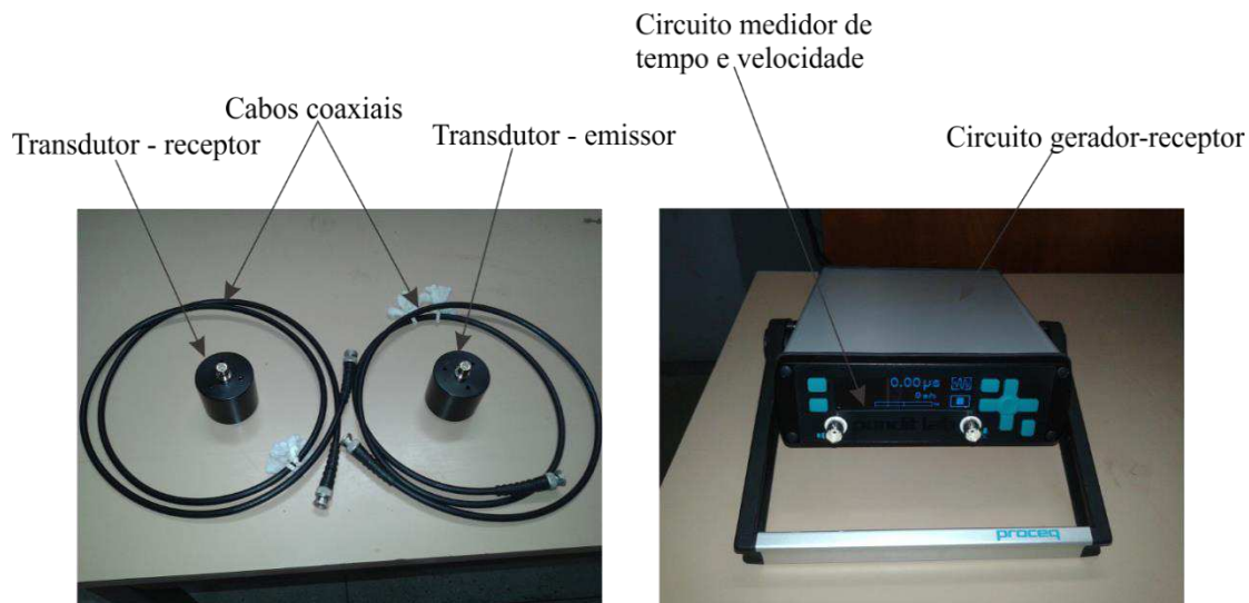
Figura 11 – Aparelhagem utilizada no ensaio de ultrassom
