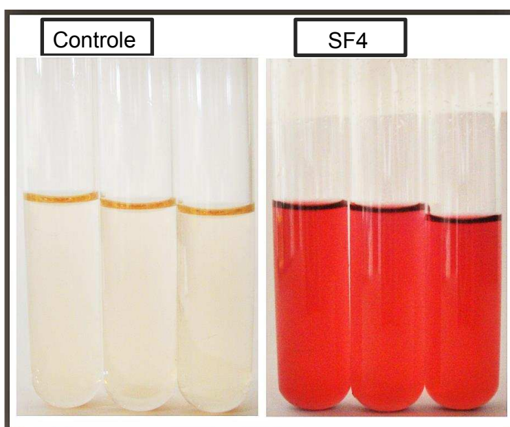
Figura 5 – Reação colorimétrica com o reagente de Salkowski, que promove o aparecimento de cor vermelha na presença de Ácido indol-acético (AIA).
