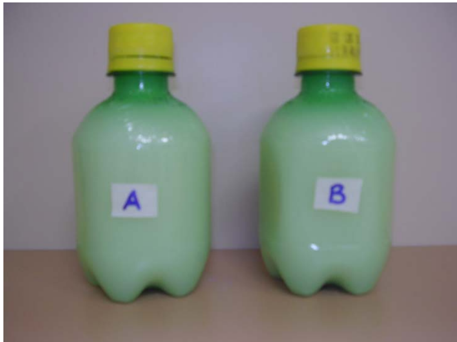
Figura 6: Bebida láctea envasada a quente. A: produto envasado a 68 °C por 12 minutos (garrafa sem deformação). B: produto envasado a 71 °C por 12 minutos (garrafa deformada).
