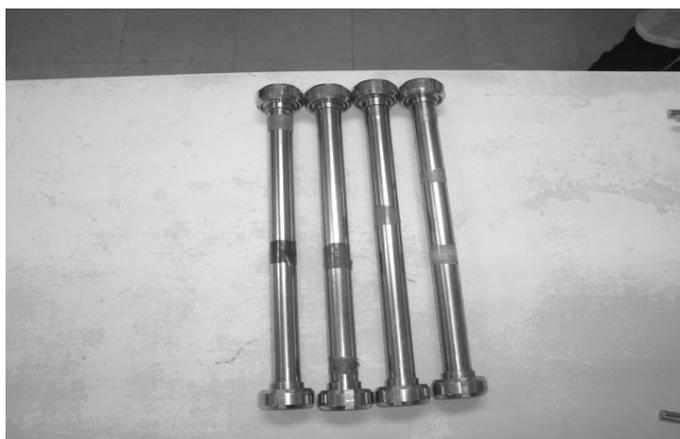
Figura 3 – Tubos de prova de aço inoxidável AISI 304 polimento nº 4, com 33 cm de comprimento e diâmetro 3,1 cm e extremidades fechadas com tampas rosqueáveis.
