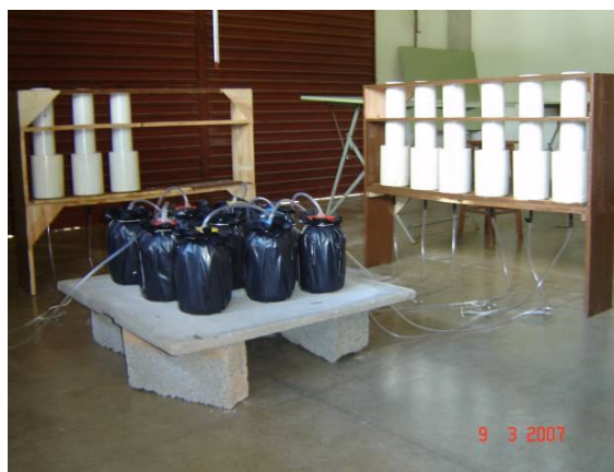
Figura 3. Vista dos biodigestores conectados a seus respectivos gasômetros.
