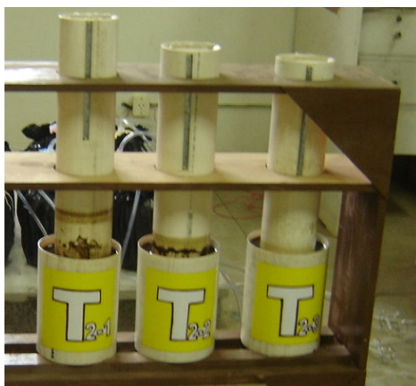
Figura 4. Vista externa dos gasômetros com o sistema em operação.
