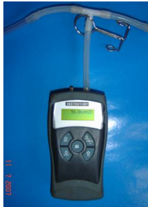
Figura 5. Manômetro usado para leitura da pressão do biogás.
