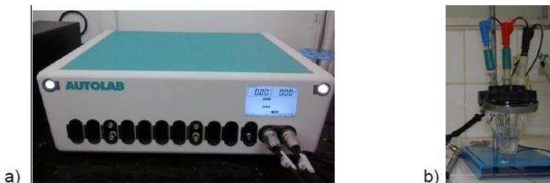
Figura 5. Instrumentação utilizada: a) potenciostato/galvanostato PGSTAT 128N e b) célula eletroquímica com arranjo de três eletrodos.
