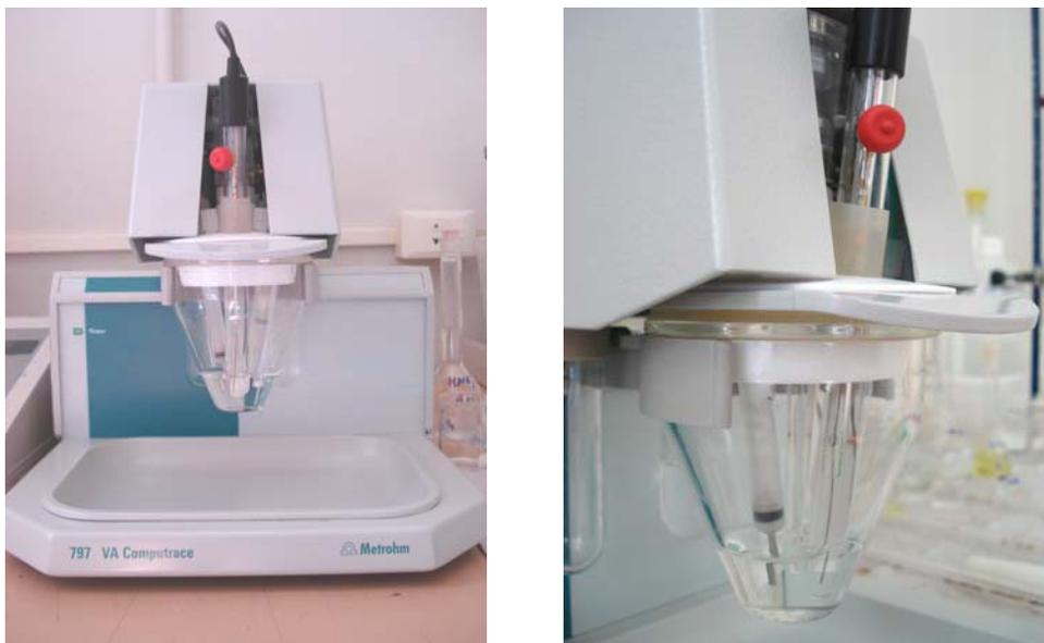
Figura 13. Medidor de pH adaptado ao aparelho 797 VA *Computrace*.
