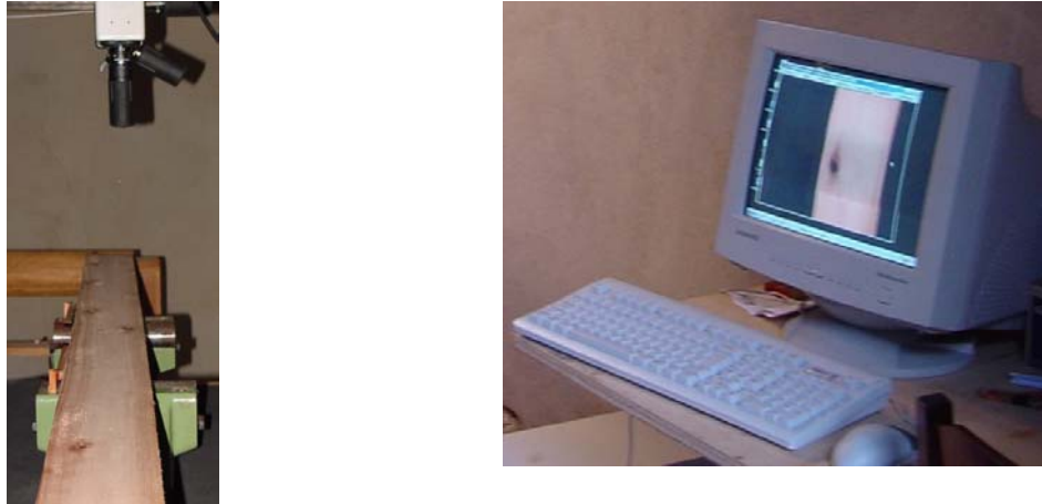
Figura 1 - Sistema de aquisição de imagens simulando uma esteira transportadora.
