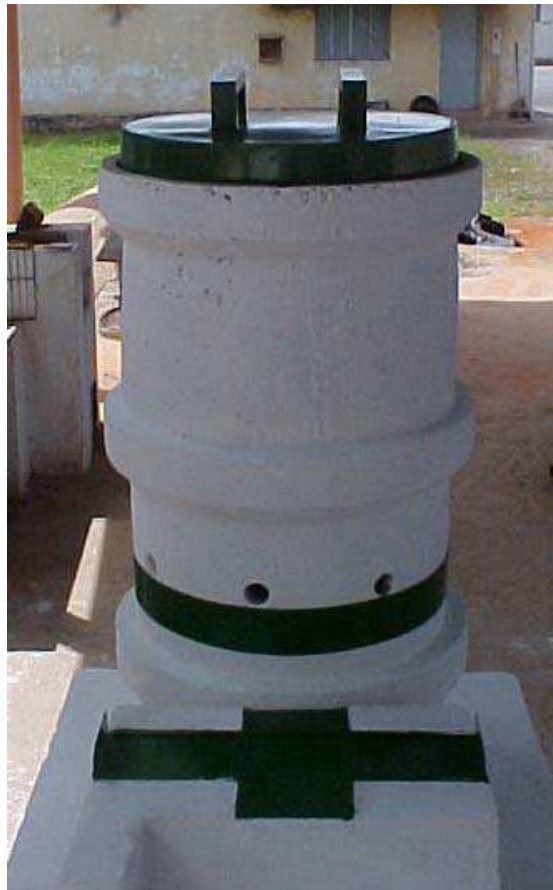
Figura 23: Detalhe da tampa do reator e das entradas de ar primário no reator.
