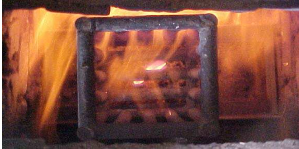
Figura 16: Combustão do gás produzido pelo reator.
