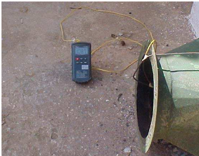
Figura 20: Ar de secagem (de saída) quente e limpo, ao sair do volume de controle.
