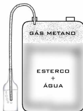
Bombona plástica adaptada para produção de biofertilizante.
