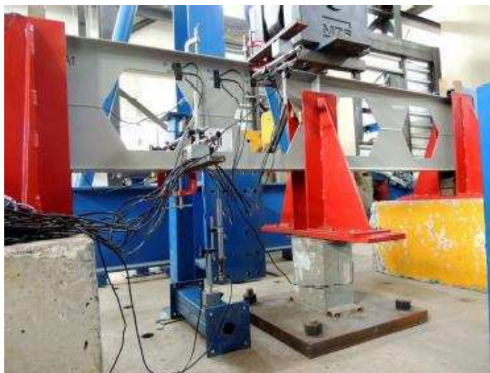
Figura 2.8 – Montagem do ensaio de vigas casteladas sujeitas a FMAV.
