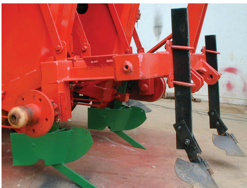
Figura 1. Vista lateral do mecanismo adaptado à plantadora, mostrando sulcador frontal, e separador do adubo com haste escarificadora.
