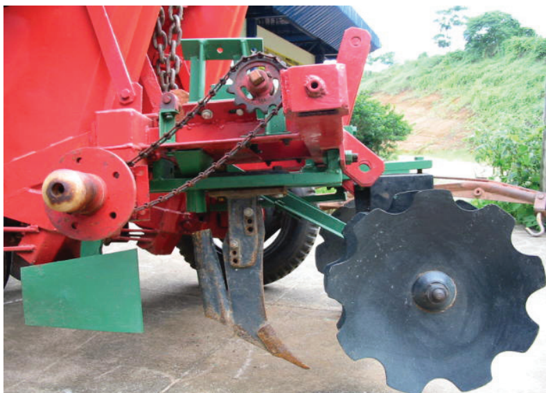
Figura 2. Vista lateral do mecanismo adaptado à plantadora, mostrando conjunto de discos de grade, sulcador tipo bota e separador de adubo.
