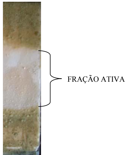
Figura 2: Foto do ensaio CCD-bioautografia, mostrando a fração ativa, obtida 7 dias após aplicação de meio de cultura contendo grande número de esporos de A. flavus (AF) sobre uma placa de cromatografia em camada delgada preparativa 20 x 5 cm [60 mg de óleo essencial, 1 mm de sílica-gel 60G F 254 e diclorometano:hexano (2:1 v/v) como eluente].
