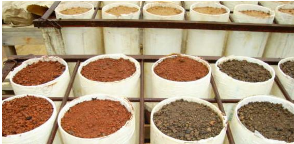
Figura 3 - Vista parcial das colunas preenchidas com os solos
