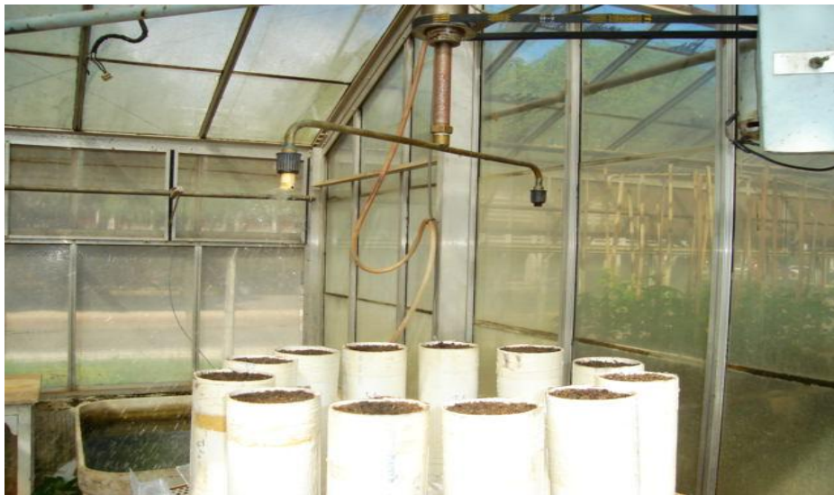
Figura 4 - Vista parcial do aparelho utilizado para a simulação da chuva no topo das colunas
