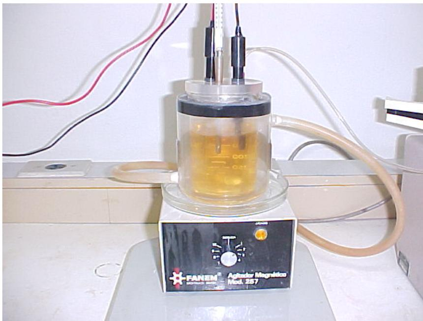
**Figura 7.** Cella utilizada para a degradação sob plasma.
