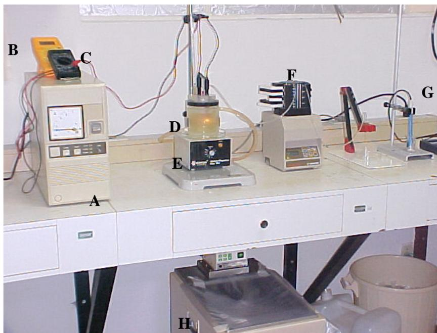
**Figura 8.** Sistema empregado para a degradação da alizarina. A, fonte de alta tensão; B, voltímetro (monitor da tensão); C, voltímetro (monitor da corrente); D, cela reacional; E, agitador magnético; F, bomba peristáltica; G, pHmetro; H, banho termostático.
