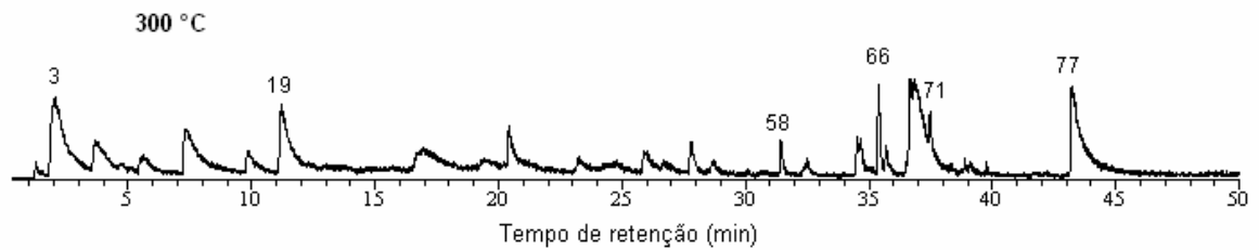
Figura 1E – Piograma da serragem livre de extrativo de E. urograndis , na temperatura de 300 °C.
