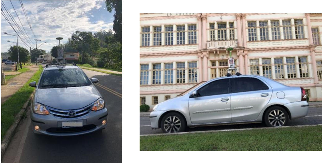
Figura 22 - Sistema do Laser scanner / GPS acoplado em um veículo.
