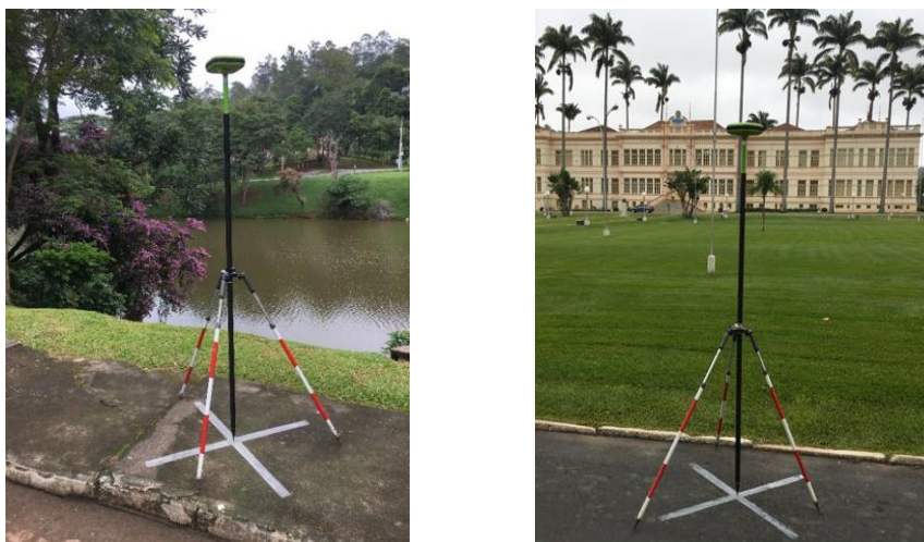
Figura 19 - Exemplo de um ponto de controle levantado em campo.
