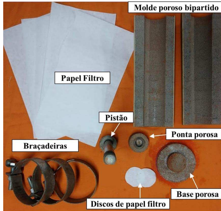
Figura 3.12 – Cilindro de paredes drenantes e dispositivos auxiliares para a reconstituição de corpos de prova por compressão de lama nas dimensões 50 x 100 mm.
