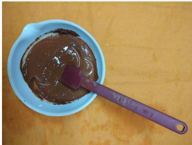
Figura 3.11 – Preparação da mistura na consistência de lama para a reconstituição por compressão de lama.
