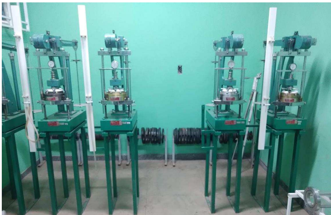
Figura 3.26 – Ensaio edométrico: equipamentos utilizados.
