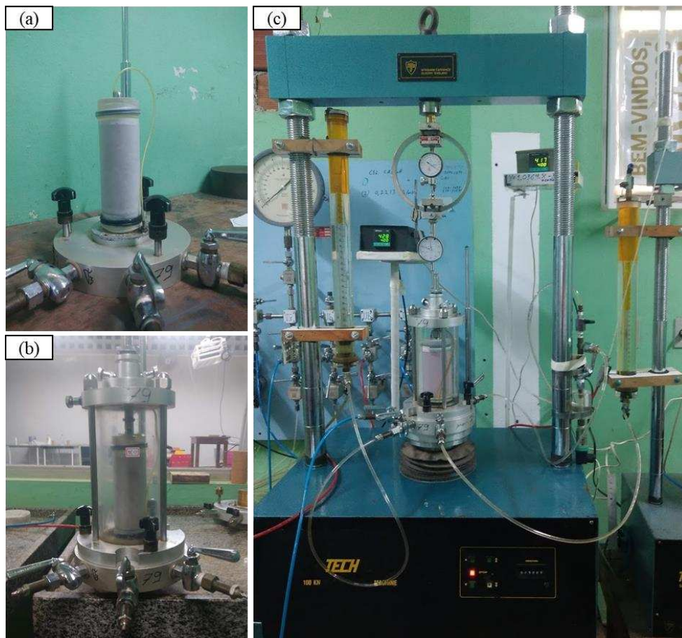
Figura 3.27 – Condutividade hidráulica: (a) e (b) montagem dos corpos de prova no permeâmetro de paredes flexíveis (célula triaxial); (c) equipamentos utilizados.
