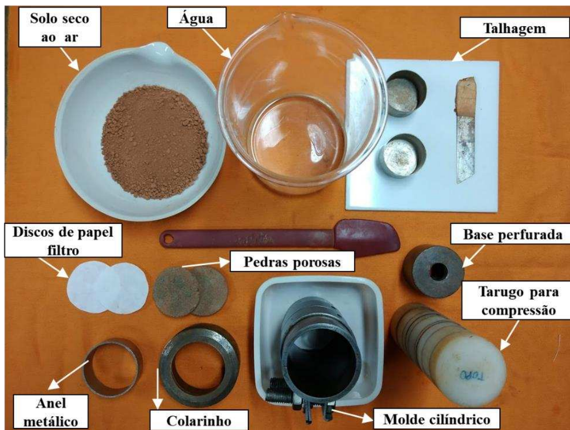
Figura 3.17 – Reconstituição por compressão de lama de corpos de prova nas dimensões (50 x 20 mm): materiais e equipamentos auxiliares.
