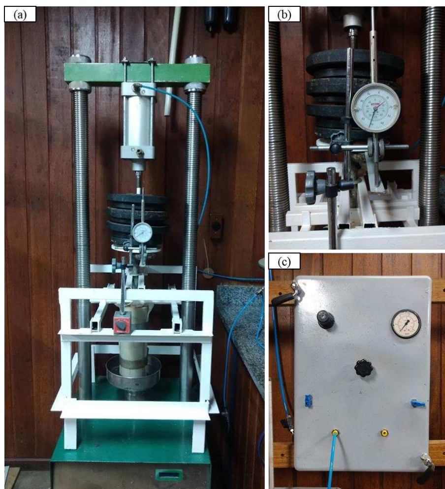
Figura 3.15 – Sistema de compressão de lama: (a) visão geral; (b) detalhe do medidor de deslocamento; (c) detalhe do painel de controle do sistema de ar comprimido.
