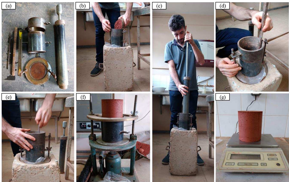
Figura 3.4 – Ensaio de compactação de Proctor Normal: (a) equipamentos utilizados; (b) deposição do solo para compactação da camada; (c) execução da compactação; (d) conferência da altura da camada; (e) escarificação; (f) extração do corpo de prova; (g) corpo de prova extraído.
