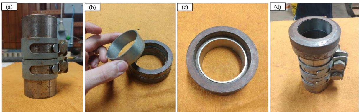
Figura 3.6 – Compactação estática e dinâmica: (a) molde cilíndrico; (b) anel edométrico e colarinho; (c) inclusão do anel edométrico ao colarinho; (d) acoplamento do colarinho com o anel edométrico ao molde.
