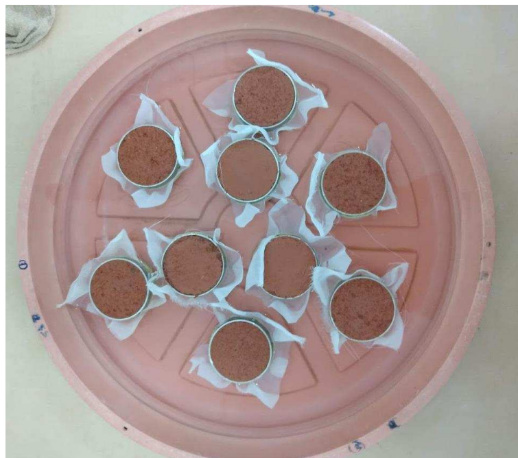
Figura 3.19 – Corpos de prova para a determinação das SWRCs pela técnica da mesa de sucção e câmara de pressão (translação de eixos).
