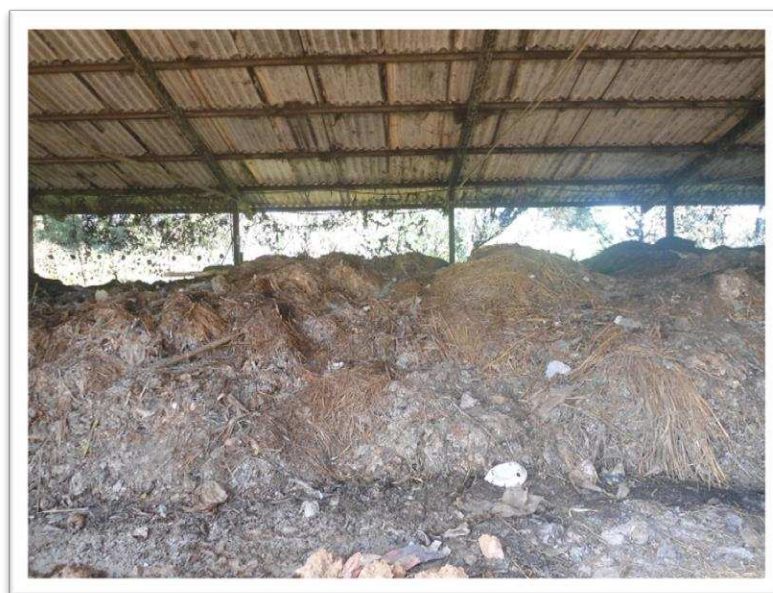
Figura 11. Leiras de compostagem primária na Usina de Compostagem Minas Organic. Fonte: o Autor, com permissão da empresa.
