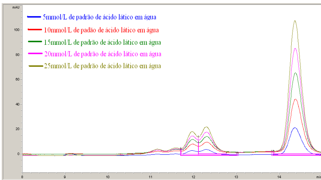
Figura 6 - Curva analítica de ácido láctico, em água, nas concentrações de 5, 10, 15, 20, 25 mmol/L, determinada por HPLC-IE.
