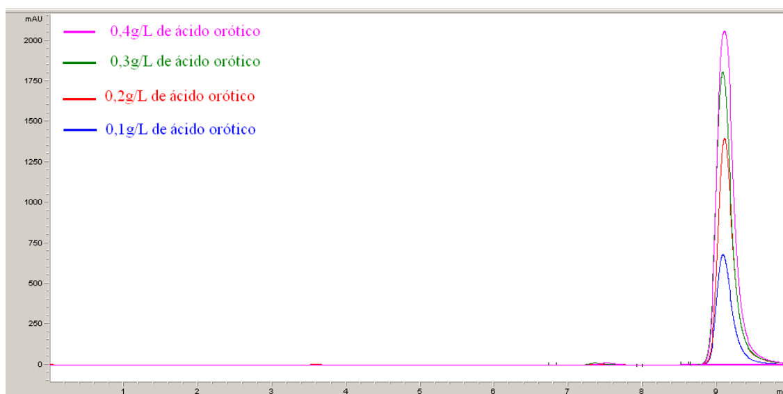
Figura 17 - Cromatograma por HPLC-IE das amostras de ácido orótico em água desionizada nas concentrações de 0,1 ; 0,2; 0,3; 0,4 g/L.
