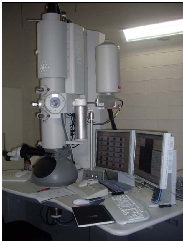
Figura 9 – Microscópio eletrônico de transmissão utilizado no experimento para caracterização das AgNPs.
