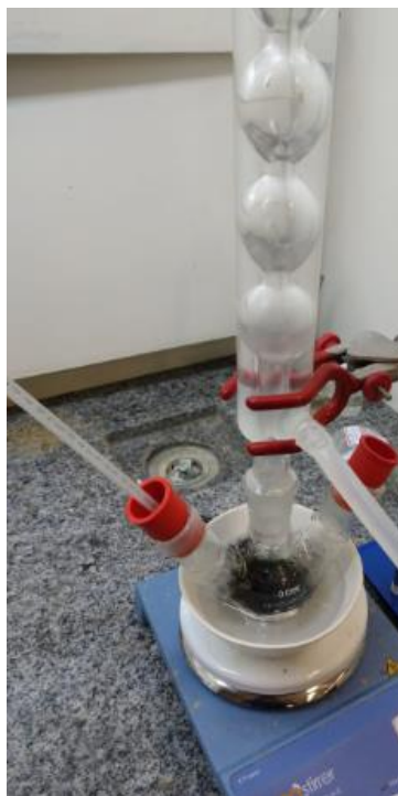
Figura 3.2. Aparato para lixiviação em refluxo do pó negro obtido das baterias NiMH.
