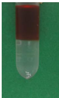
Figura 3.8. Sistema composto por L64 + Tiosulfato de sódio + lixiviado com adição de 1N2N em proporção molar 10:1 para cobalto.
