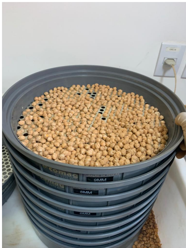
Figura 2. Jogo de peneiras utilizados para classificação de sementes de grão-de-bico em diferentes tamanhos.
