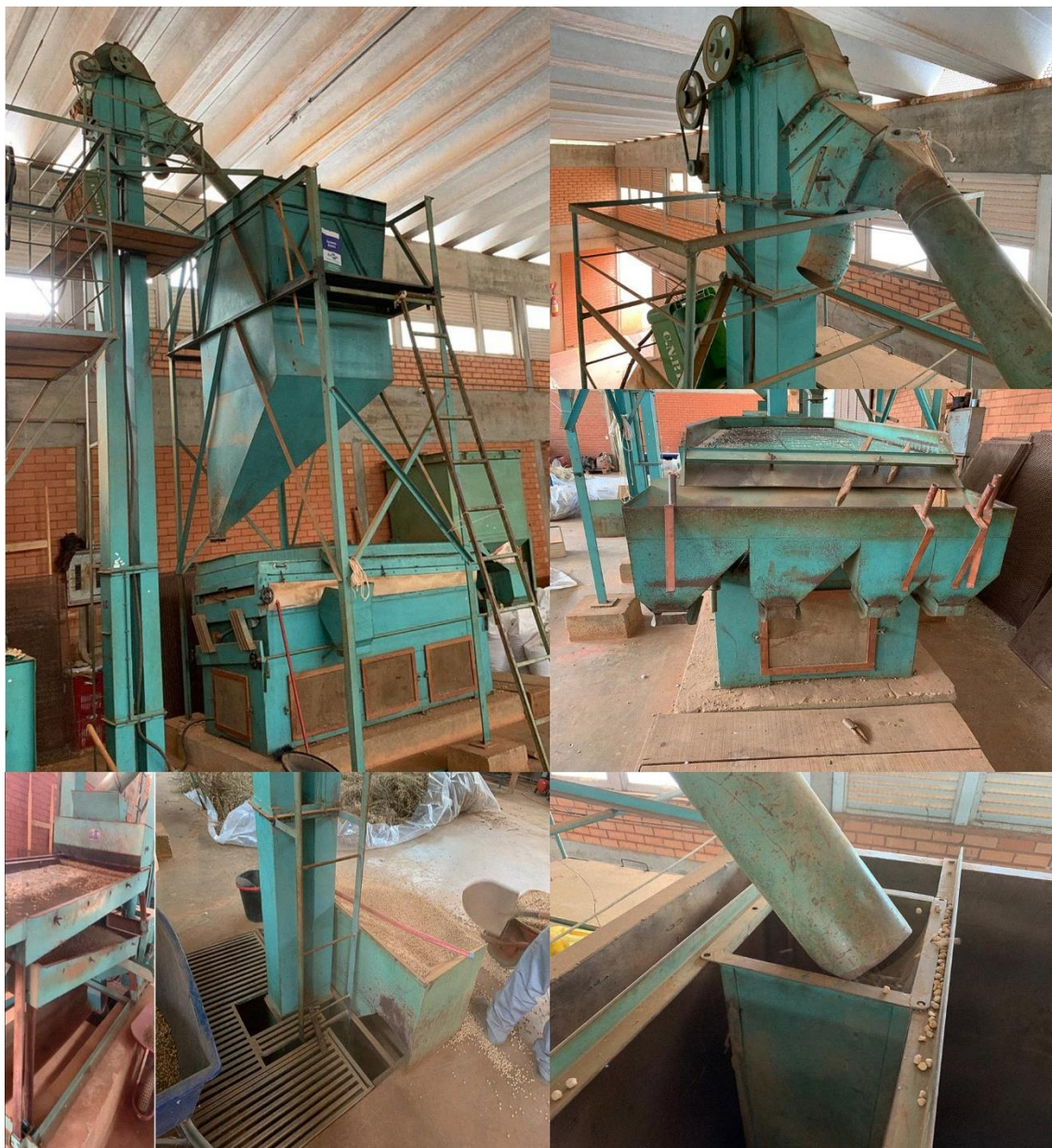
Figura 3. Linha de beneficiamento da Embrapa Hortaliças, constituída de: moega, elevador de canecas 1, máquina de ventilador e peneiras, elevador de canecas 2, silo armazenador e mesa de gravidade (descarga superior, intermediária alta, intermediária baixa e inferior).
