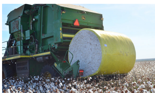
Figura 202 - Colheita com máquina de rolo com peso aproximado de 2,2 t. de algodão em caroço. Totalmente automatizada, tem apenas um operador. UP Guapirama
