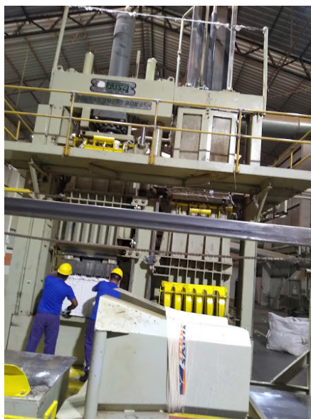
Figura 235 - À esquerda, fardo pronto sendo amarrado. À direita, fardo sendo compactado. UP Ribeiro do Céu
