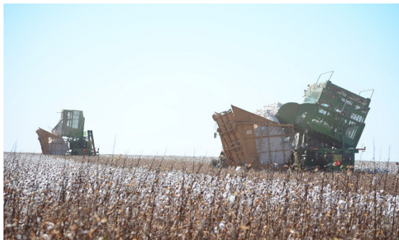
Figura 204 - Descarregamento em bass boy de duas máquinas de cesto em pleno talhão. UP Guapirama
