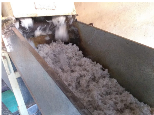
Figura 250 - Bica que recebe as fibras curta, imaturas que formam as "fibrilhas". UP Guapirama
