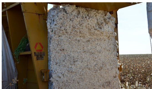
Figura 209 - Fardo pronto: a prensa montada sobre um eixo é suspensa e puxada por um trator para liberar o fardo. UP Guapirama
