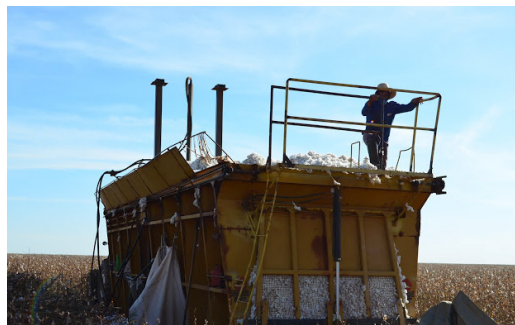
Figura 207 - Prensa ligada à tomada de força de um trator e, por meio de um pistão hidráulico, compacta o algodão e faz um fardo de 10 t, que depois será transportado para usina
