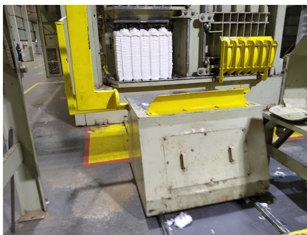
Figura 246 - Fardo de 202 kg, devidamente prensado e amarrado. UP Ribeiro do Céu
