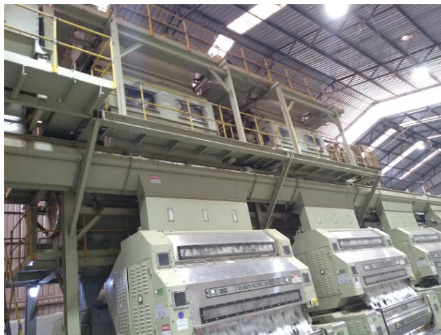
Figura 240 - No alto e acima, estão os batedores de 2º estágio e, logo abaixo, a rosca alimentadora seguida das máquinas descaroçadoras. UP Ribeiro do Céu
