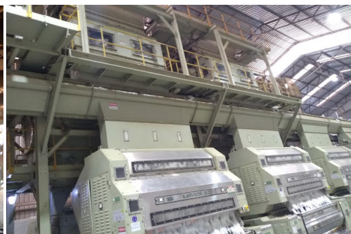
Figura 234 - Rosca alimentadora, abaixo do batedor de 2º estágio e acima do descarçador
