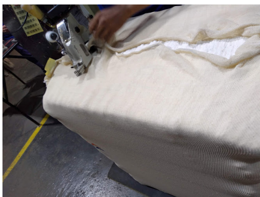
Figura 248 – Fardo, após receber a capa de tecido de algodão, é costurado e etiquetado. UP Ribeiro do Céu
