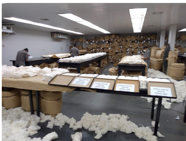
Figura 255 - Sala de classificação: lotes sendo preparados, blocos de amostras já classificados e as caixas-padrão em cima da mesa para facilitar o processo de classificação
