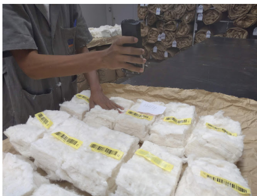
Figura 257 - Blocos de amostras já classificados e com código de barra sendo identificados pelo infravermelho para posterior composição dos lotes
