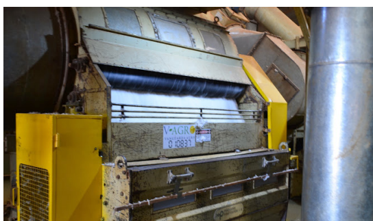
Figura 244 - Condensador limpador de pluma, etapa após o descarçamento. UP Guapirama
