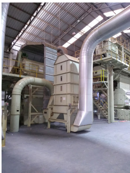
Figura 238 - Torre de secagem: o algodão recebe mais um pouco de calor fazendo mais um processo. Acima e ao fundo, encontra-se o batedor para retirada de folhas e caule
