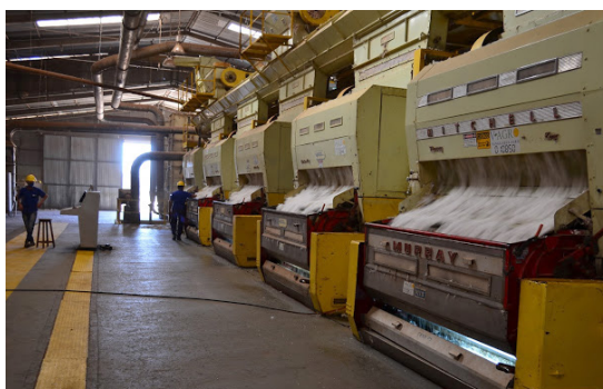
Figura 241 - Máquinas descaroçadoras da UBA (Usina de Beneficiamento de Algodão). UP Guapirama
