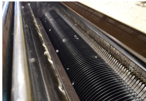
Figura 242 - Conjunto de serras que compõem a máquina de descaroçamento, cujo objetivo é separação da fibra do caroço. UP Guapirama
