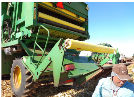
Figura 211 - Máquina de rolo sendo abastecida com as bobinas de filme de plástico que vão cobrir o algodão em caroço durante o processo de colheita. UP Guapirama
