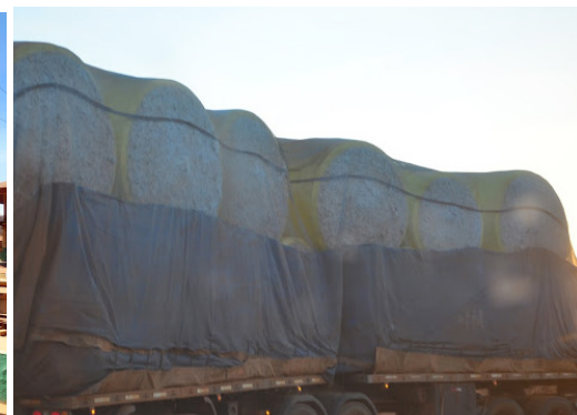
Figura 216 - Transporte de rolinhos da lavoura para o pátio da usina: recobertos por uma lona, chamada de touca, para evitar a contaminação por poeira durante o trajeto. UP Mãe Margarida/ Ribeiro do Céu
