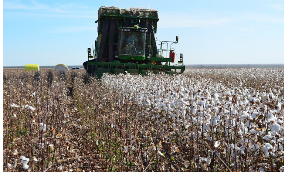
Figura 203 - A frente da máquina de rolo e o processo de colheita são iguais às da máquina de cesto, porém, a eficiência e a rapidez na colheita são bem superiores
