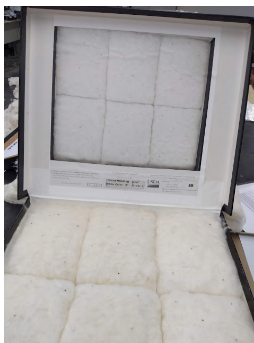
Figura 258 – Caixa-padrão com amostra de fibra de algodão feito pelo USDA-EUA, aceito e usado por diversas entidades no mundo
