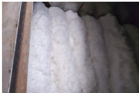
Figura 245 - Condensador principal: pluma pronta para ser enfardada. UP Ribeiro do Céu
