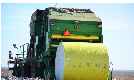
Figura 213 - Rolinho depois de pronto, sendo liberado pela máquina no próprio talhão. UP Guapirama
