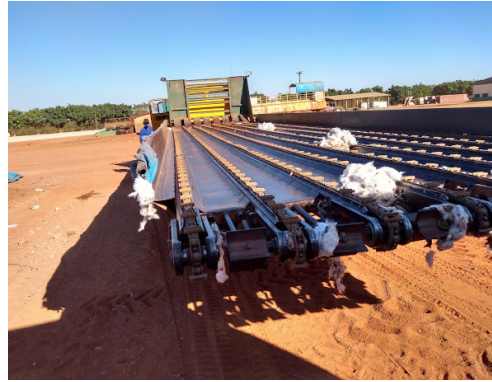
Figura 218 - Transmódulo que transporta o fardão para o pátio e depois dali para dentro da usina. UP Guapirama
