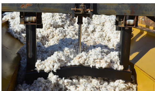
Figura 208 - Pistão hidráulico prensando o algodão em caroço, recém-colhido, para formar um fardão. UP Guapirama
