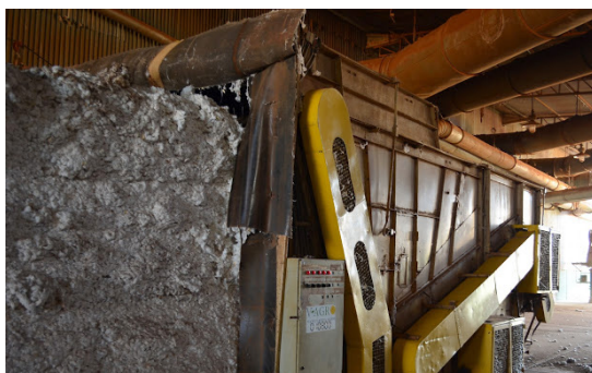
Figura 233 - Descompactadora (piranha) descompactando o algodão. UP Guapirama
