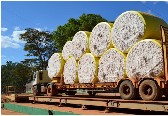
Figura 217 - Pesagem dos rolinhos que vieram da lavoura, antes de serem armazenados no pátio da usina, UP Guapirama
