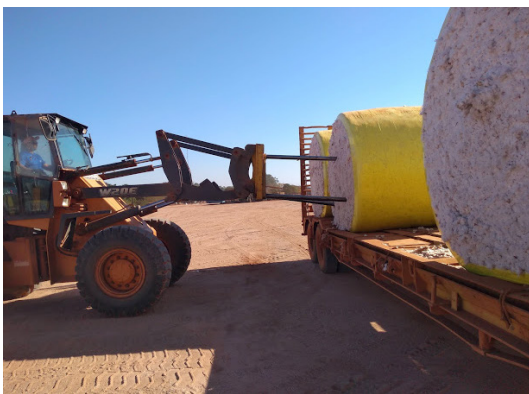
Figura 221 - Descarregamento dos rolinhos com auxílio de uma carregadeira, com uma espécie de tridente na frente, que espeta o rolinho e deposita no pátio. UP Guapirama
