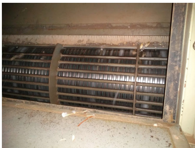
Figura 239 - HLST limpador extrator – elimina as cascas do capulho
