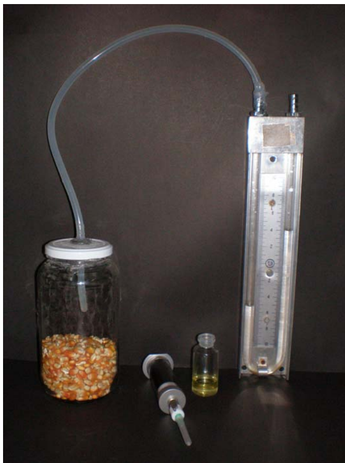
Figura 1 – Aparato utilizado para o estudo do mecanismo de sorção.
