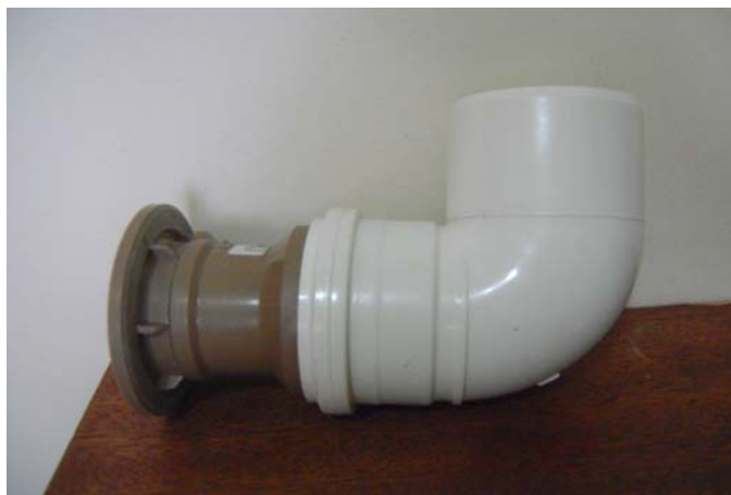
Figura 0.10 - Conexão da base do equipamento com o início do compartimento catódico.
