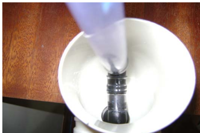
Figura 0.6 - Representação da entrada de água e sistema de resfriamento situados no compartimento catódico do equipamento UFV-Água, atuando como amenizador da temperatura.
