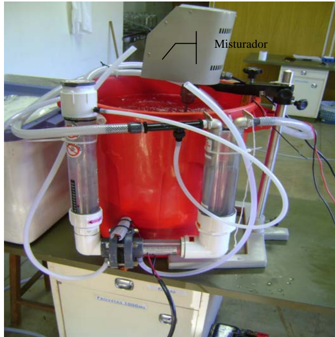
Figura 0.11 - Representação do equipamento Original em operação durante ensaios de produção de gases oxidantes.
