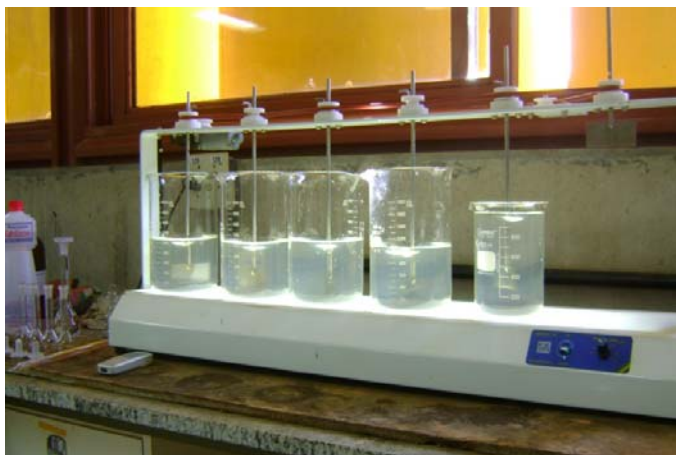
Figura 0.15 - Representação do ensaio de desinfecção utilizando água natural.
