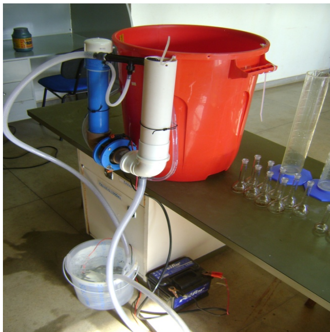
Figura 0.14 - Representação do equipamento UFV-Água na produção da solução desinfetante.
