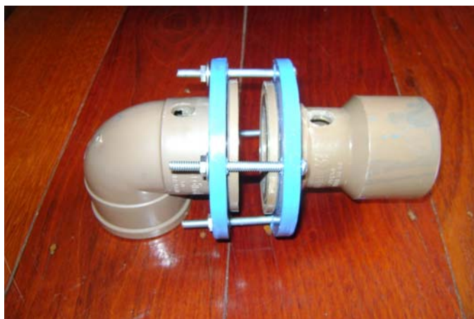
Figura 0.5 - União da base dos compartimentos do equipamento com uso de flanges em PVC.
