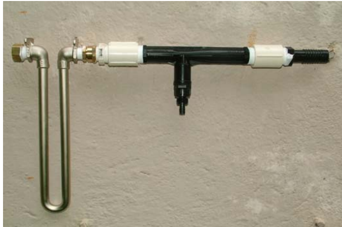
Figura 0.5 - Representação do trocador de calor situado no compartimento catódico do equipamento Original.
