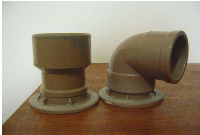
Figura 0.4 - Componentes da base do equipamento após soldagem com uso de cola para PVC.
