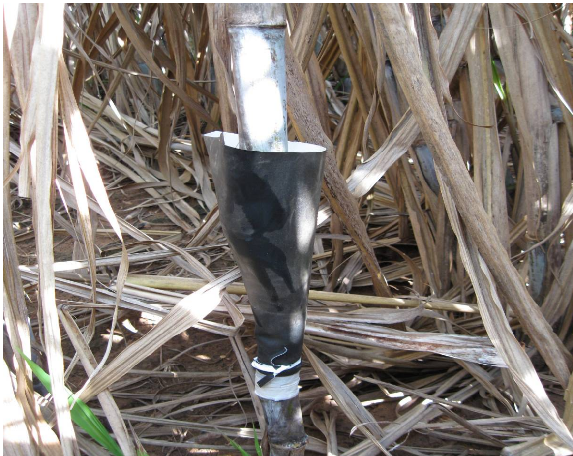
Figura 4: Revestimento do colmo da cana de açúcar utilizado para captar o volume de água escoado.
