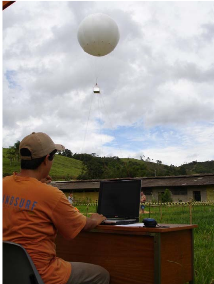
Figura 8. Aquisição das imagens no sistema de sensoriamento remoto utilizando o balão com gás hélio.
