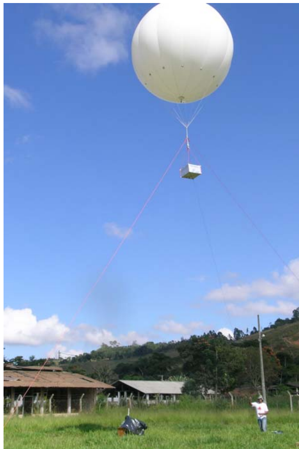
Figura 7. Sistema de sensoriamento remoto utilizando o balão com gás hélio imageando as parcelas na área experimental.
