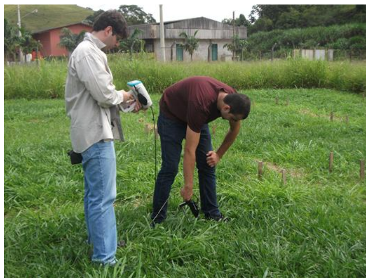
Figura 4: Leitura de refletância das plantas utilizando instrumento ASD Field SpecPro espectrômetro FR (Analytic Spectral Devices, Boulder, EUA), com o adaptador “plant probe”.
