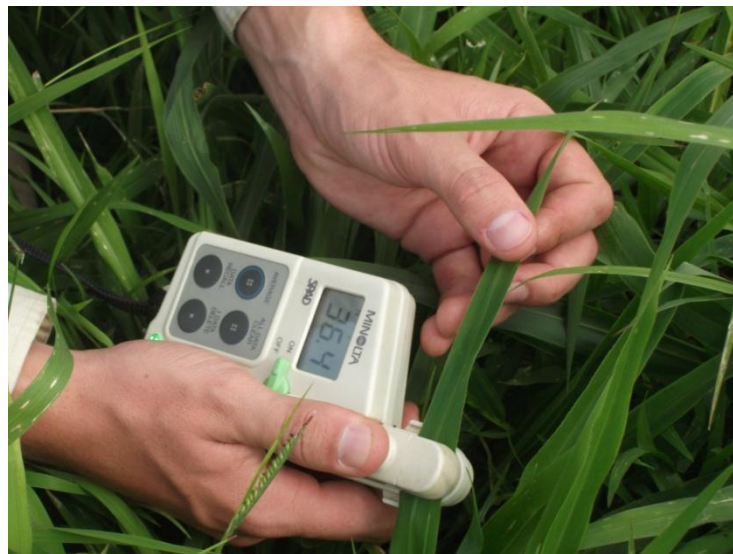
Figura 3: Leitura da variável espectral com clorofilômetro portátil, SPAD 502.
