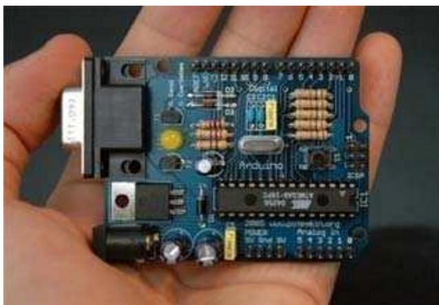
**Figura 16** - Microcontrolador ARDUINO/ATMEGA328P.
