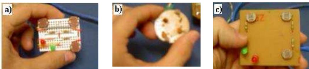
**Figura 12** - Geometrias testadas para a unidade de sensoriamento: a) geometria retangular, b) geometria circular, c) geometria quadrada.
