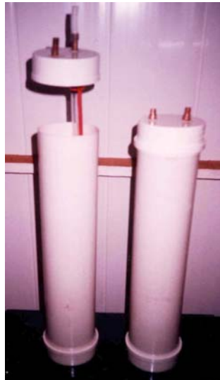
Figura 8 – Dispositivo utilizado para neutralidade do efeito parede.
