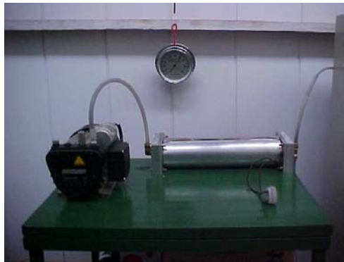
Figura 6 – Compressor de ar e filtro de Alumina.
