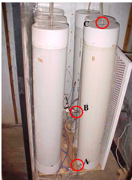
Figura 3 – Recipientes cilíndricos: A) Entrada de ozônio, B) Ponto de inserção dos sensores de monitoramento da temperatura da massa de grãos e C) Saída de ozônio.
