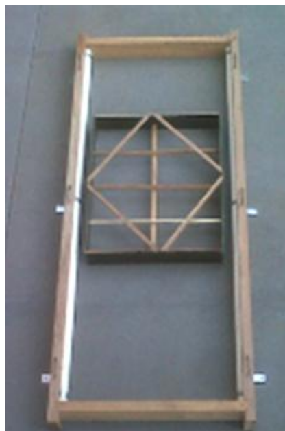
Figura 13 – Fôrma para o painel com janela.
