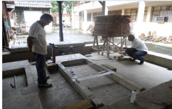
Figura 26 – Montagem do ensaio de compressão horizontal do painel com porta.
