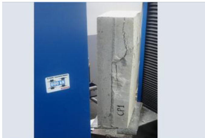
Figura 49 – Corpo de prova com fissuração, rompido por compressão.
