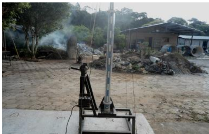
Figura 42 – Equipamento e painel preparado para o ensaio de corpo duro.
