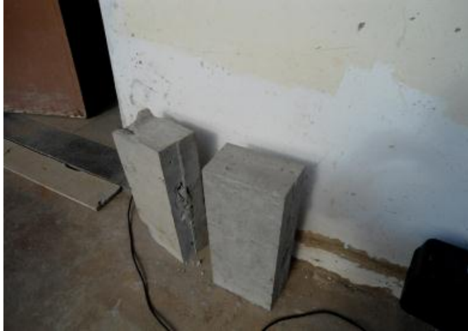
Figura 29 - Prismas para ensaio de compressão, obtidos dos painéis modulares.
