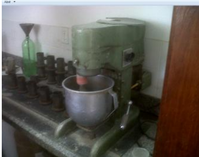
Figura 33 - Misturador de bancada utilizado no experimento.
