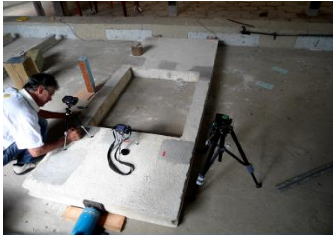
Figura 27 – Montagem do ensaio de compressão horizontal do painel com janela.
