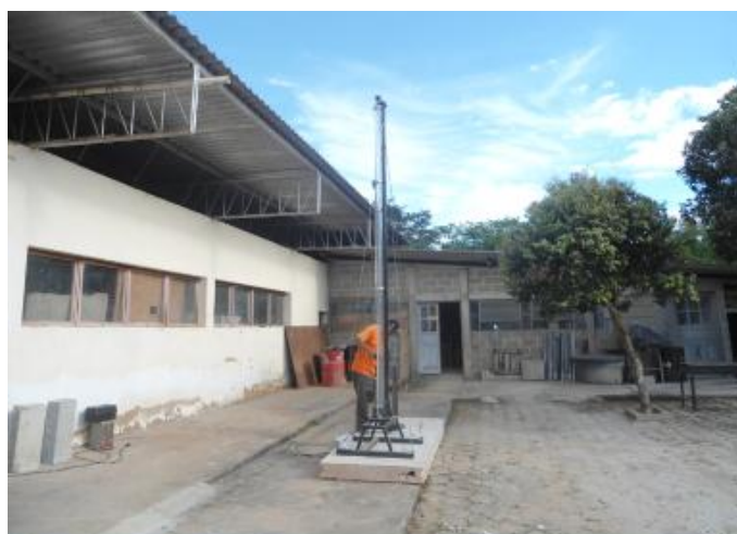
Figura 28 – Torre para ensaio de corpo duro.
