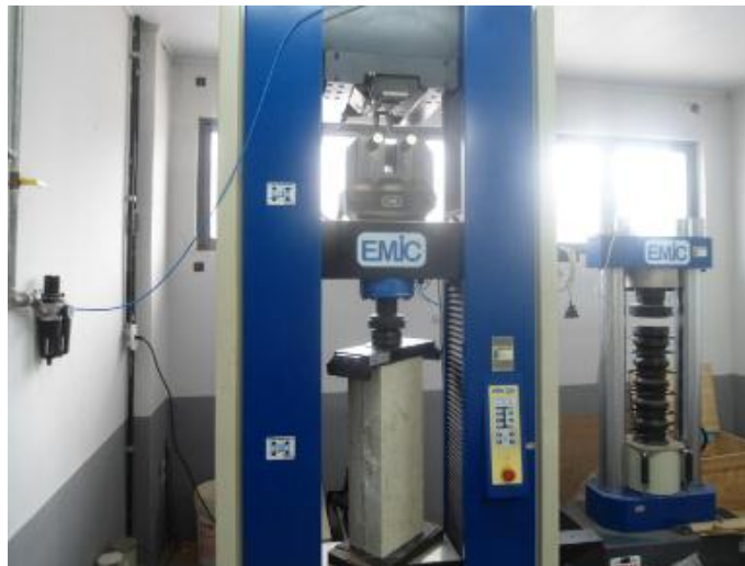
Figura 30 – Vista de uma prensa EMIC-DL 60000 onde foram executados os ensaios de compressão vertical.
