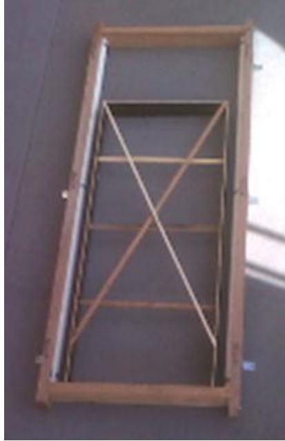
Figura 14 - Fôrma para o painel com porta.
