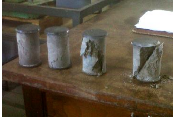
Figura 40 – Exemplo de corpos de prova rompidos no 28º dia.
