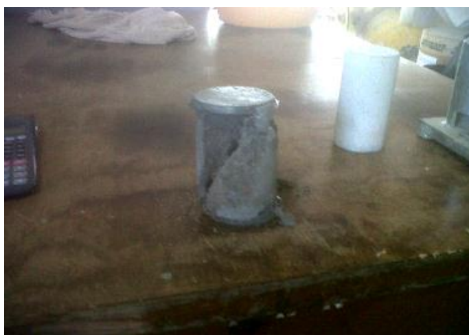
Figura 38 – Exemplo de um corpo de prova rompido no 3º dia.
