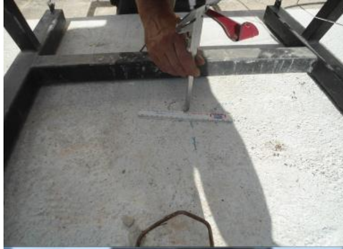
Figura 45 – Deformação superficial causada pelo impactador.
