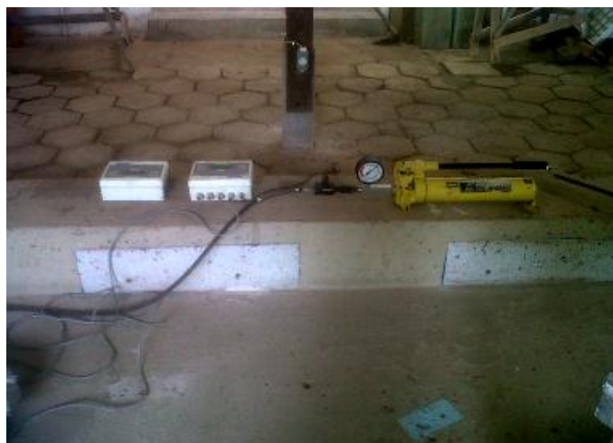
Figura 41 – Leitores eletrônicos das células de carga e macaco hidráulico empregado nos ensaios.
