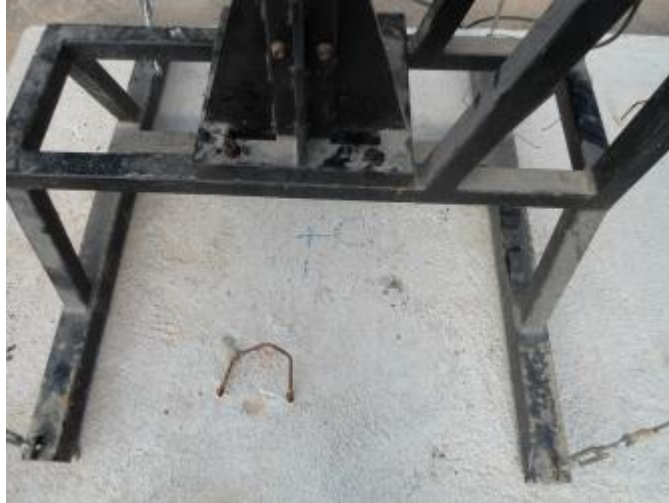
Figura 43 – Equipamento posicionado sobre o painel modular para ensaio de corpo duro.
