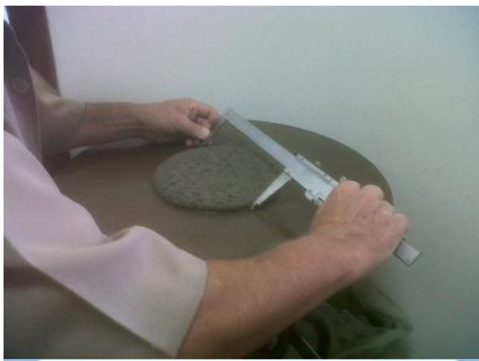
Figura 35 – Medição do diâmetro da amostra após a vibração.
