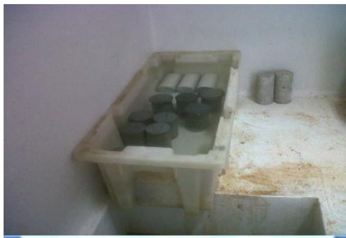
Figura 36 - Corpos de prova imersos em solução água e cal.
