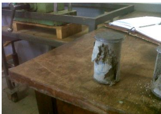
Figura 39 – Exemplo de um corpo de prova rompido no 7º dia.
