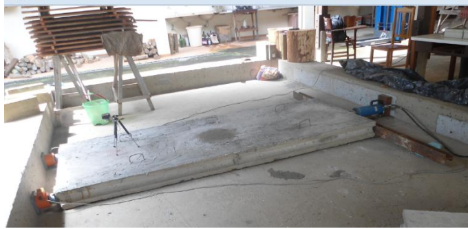
Figura 25 – Montagem do ensaio de compressão horizontal do painel cego.
