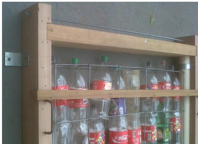
Figura 11 - Junção da cabeça da fôrma com entalhes, parafuso com rosca sem fim, alças com barras de aço redondas, cantoneiras de abas iguais e semi-tubos de PVC.
