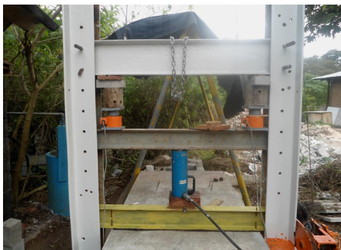
Figura 50 – Ensaio de Flexão de um painel modular na horizontal, sendo carregado no centro.
