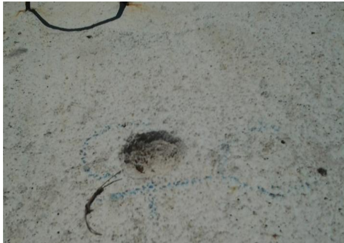
Figura 46 – Deformação superficial após 10 impactos de três alturas consecutivas.
