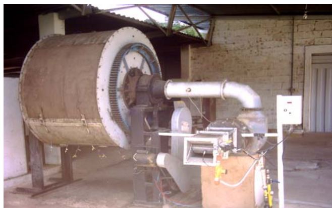
Figura 6 – Secador rotativo modificado com distribuição radial do fluxo de ar e o gerador de calor.
