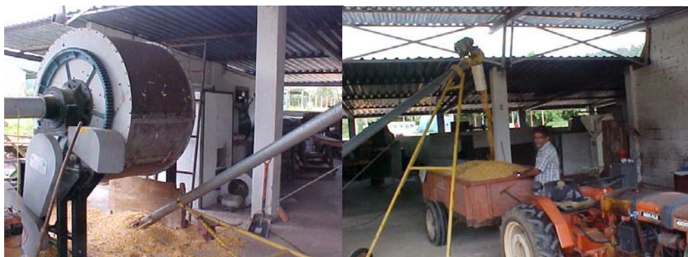
Figura 2 – Transportador helicoidal utilizado para a carga e descarga dos secadores.
