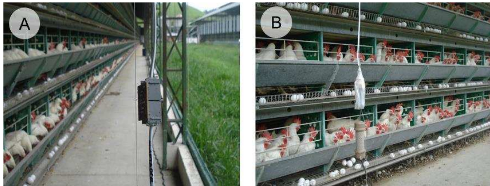
Figura 3 - Vista parcial do aviário com os sensores de temperatura do ar (A) e umidade relativa do ar (B) posicionados nas extremidades laterais da instalação.
