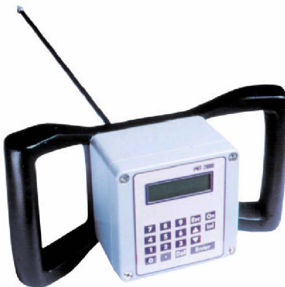
FIGURA 3. Penetrômetro utilizado para determinar a resistência do solo à penetração.
