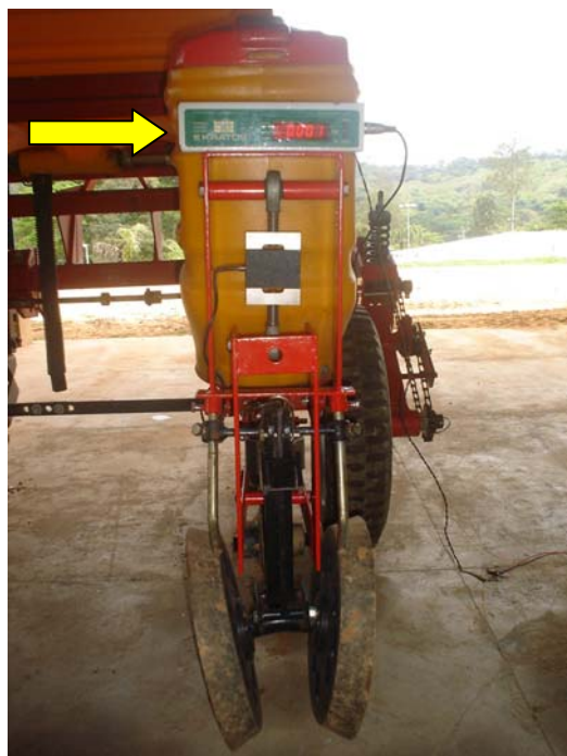
FIGURA 7. Visor conectado à célula de carga para a obtenção das cargas aplicadas pelas rodas compactadoras
