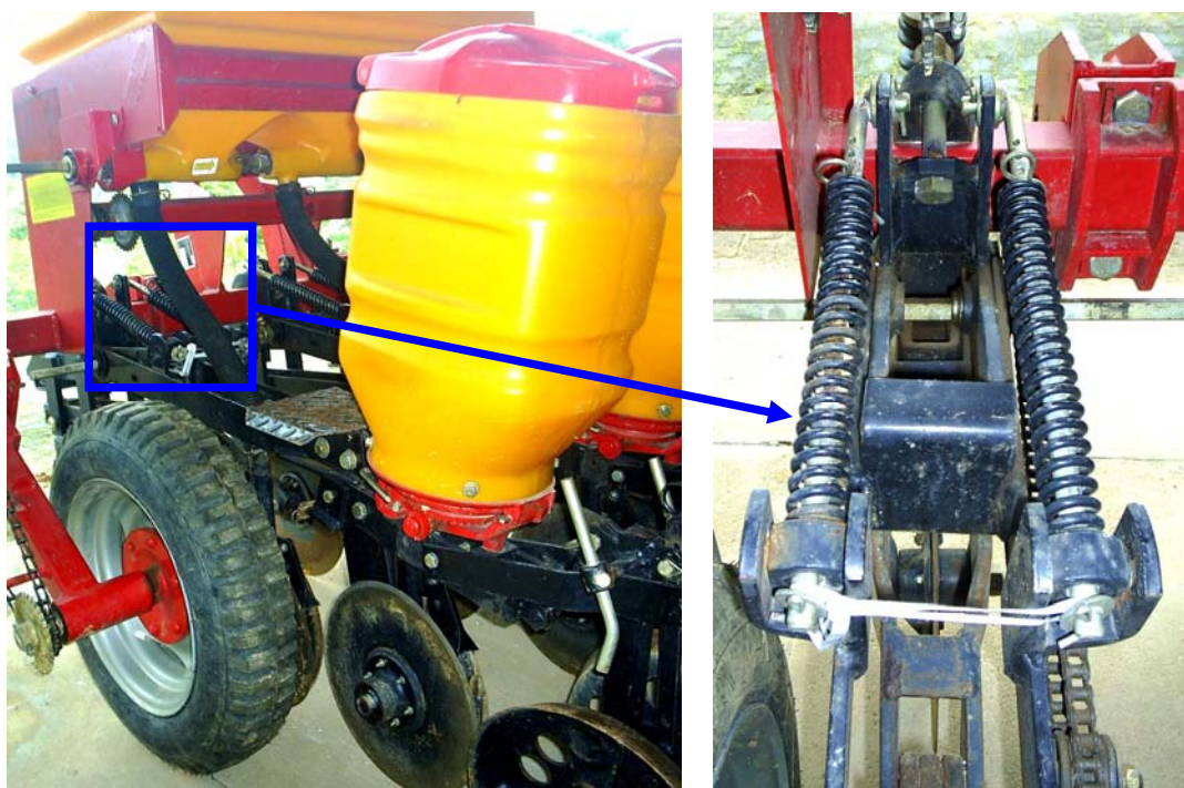
FIGURA 8. Molas utilizadas para modificação da carga nas rodas compactadoras da semeadora-adubadora
