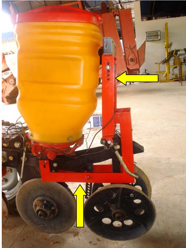
FIGURA 6. Unidade de semeadura com estrutura adaptada para instalação da célula de carga
