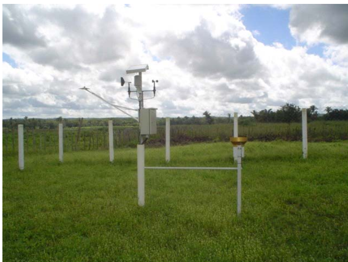
Figura 10. Estação meteorológica utilizada para o manejo da irrigação do experimento.
