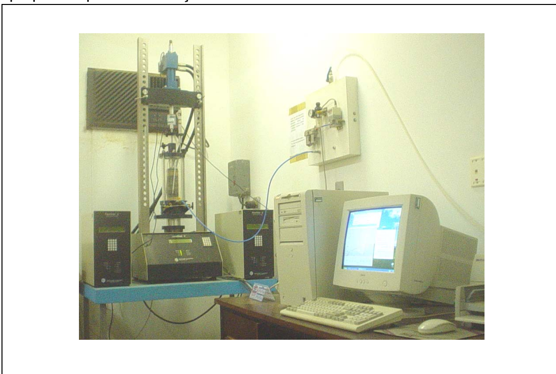
Figura 3.2 Vista geral do equipamento triaxial de cargas repetidas do Laboratório de Geotecnia – Departamento de Engenharia Civil - UFV
