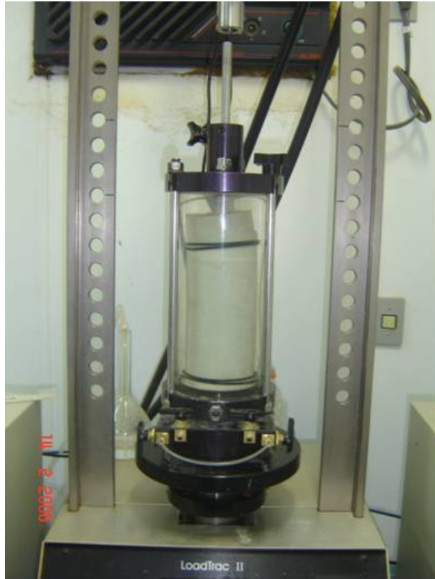
Figura 22 - Célula triaxial utilizada em ensaios triaxiais cíclicos.
