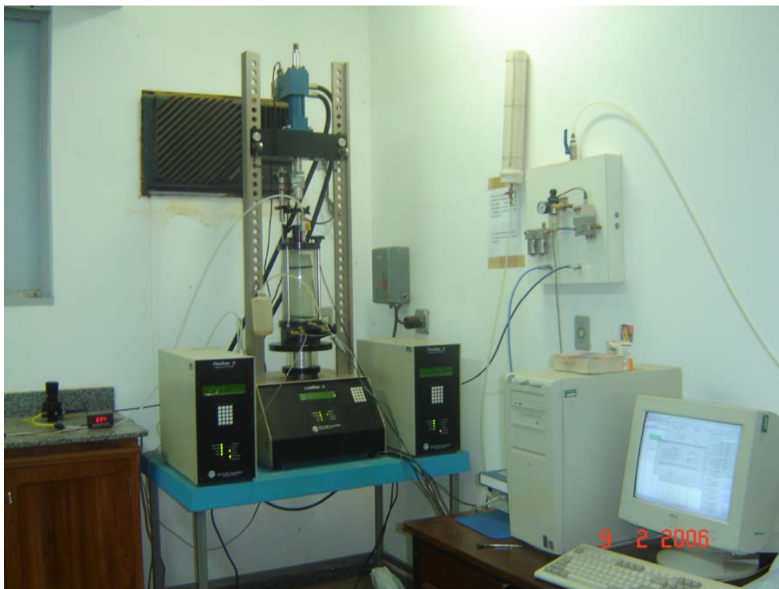
Figura 45 -Foto do equipamento utilizado para realização de ensaios triaxiais cíclicos no LEC/UFV.
