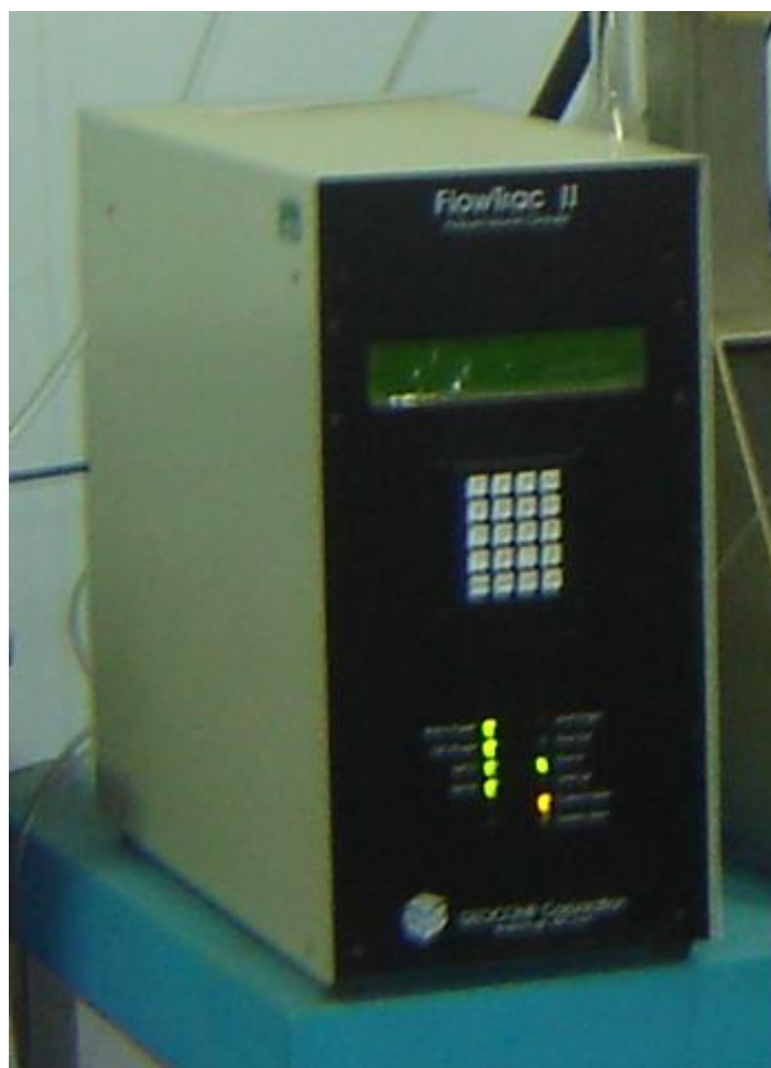
Figura 31 - Unidade controladora de pressão (Flow Trac).
