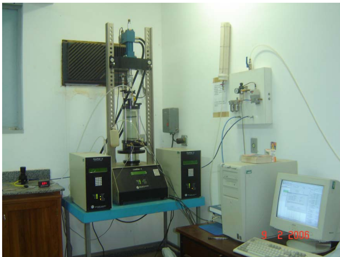
Figura 27 - Equipamento triaxial dinâmico do Laboratório de Engenharia Civil da Universidade Federal de Viçosa.
