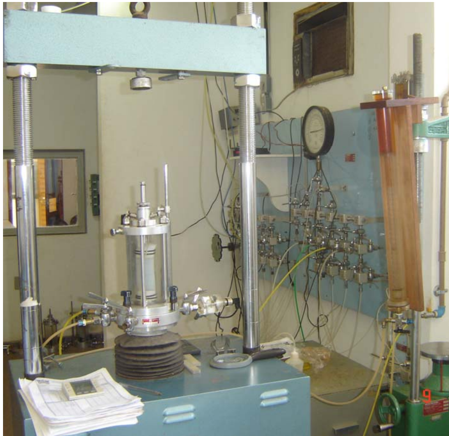
Figura 25 - Ensaio de adensamento hidrostático em andamento.
