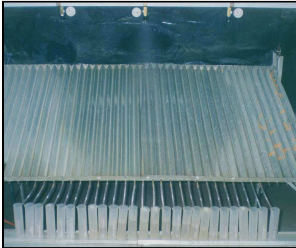
Figura 2 - Bancada de ensaios de uniformidade de distribuição volumétrica.
