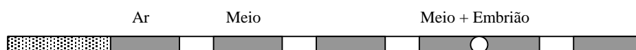
Figura 1 – Desenho esquemático da disposição das colunas de ar, meio de manutenção e do embrião na palheta francesa durante o envasamento.
