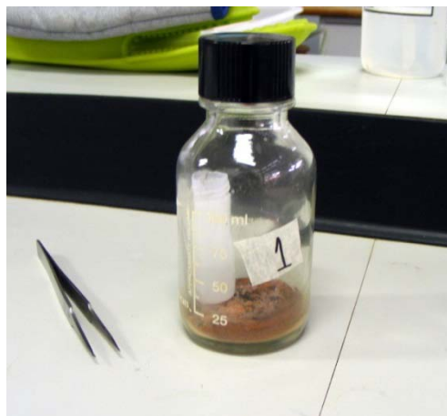
Figura 5 - Aparato respirométrico utilizado para avaliação da degradação do ^{14}\text{C} -fenantreno. Foram utilizados 10 gramas de solo seco, contaminado com ^{14}\text{C} -fenantrenonas concentrações de 1, 10, 40 e 100 \mu\text{g g}^{-1} . O ^{14}\text{CO}_2 liberado foi capturado em 2 mL de uma solução de KOH a 1 mol \text{L}^{-1} , contida em um frasco de cintilação líquida.
