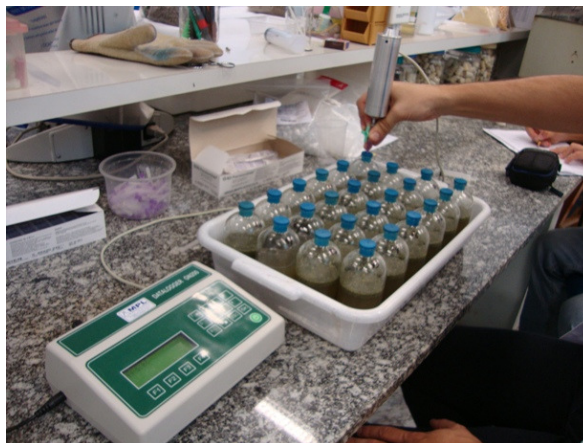
Figura 3 - Verificação da pressão de gás.
