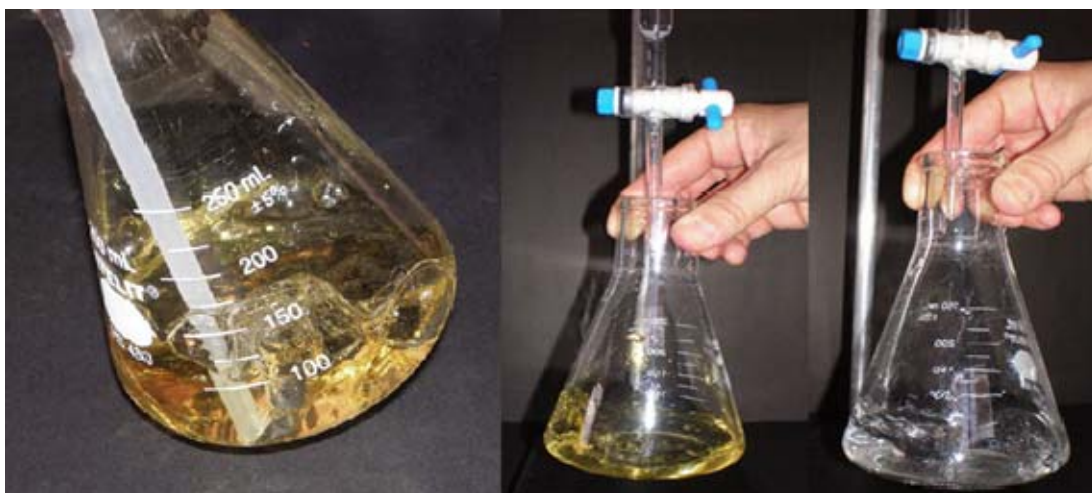
Figura 5 – Procedimento para quantificar o ozônio na corrente gasosa: (A) borbulhamento do O_3 em solução de KI e (B) titulação com Na_2S_2O_3 .
