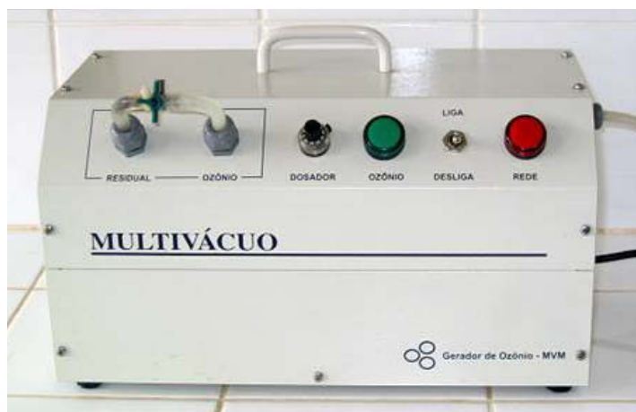
Figura 3 – Equipamento gerador de ozônio.
