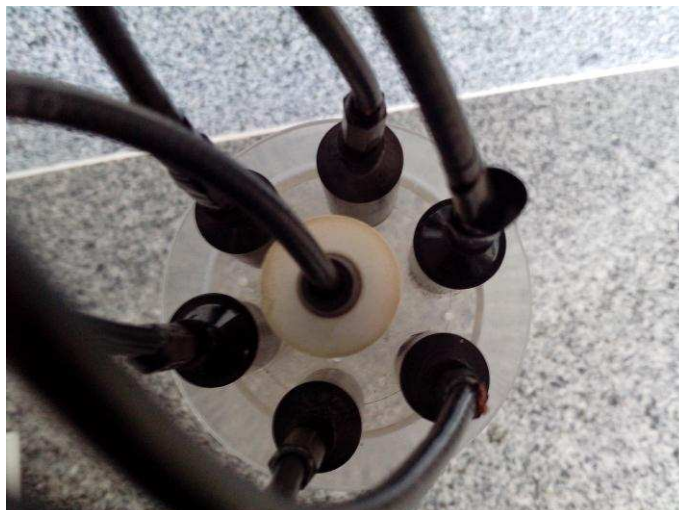
Figura 4. Tampa de acrílico com o cátodo e os seis ânodos, entre os ânodos estão localizados os orifícios para retirada de alíquotas e medição de temperatura.
