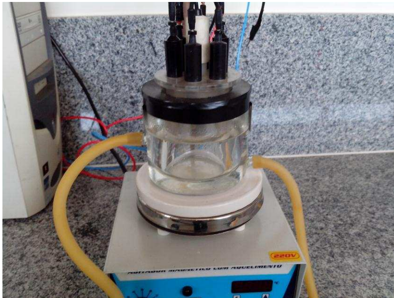
Figura 3. Cella de parede dupla montada com os eletrodos, agitador magnético e tubulação para circulação de água do banho termostático.
