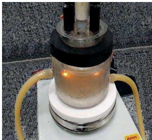
Figura 7 b). Sistema eletroquímico em funcionamento com 2 ânodos ligados.
