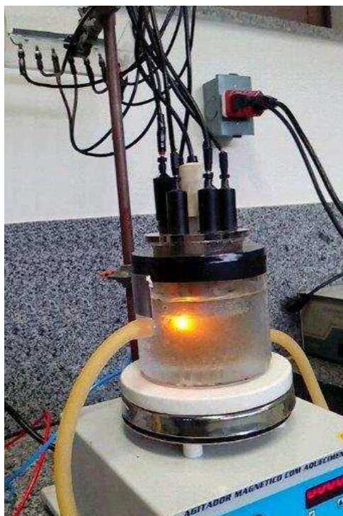
Figura 7 a). Sistema eletroquímico em funcionamento com 1 ânodo ligado.
