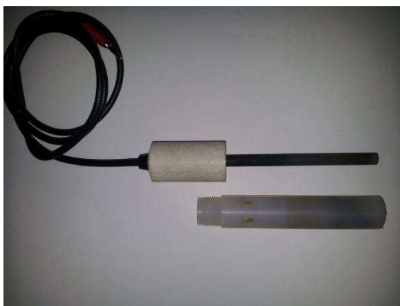
Figura 6. Eletrodo de grafite, utilizado como cátodo.
