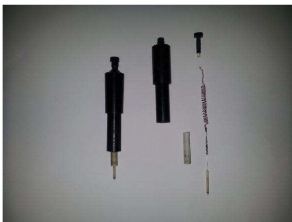
Figura 5. Micro-eletrodo de platina, utilizado como ânodo.
