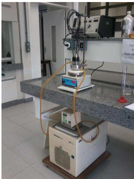
Figura 2. Foto apresentando a fonte, o banho termostático e a cela sobre o agitador magnético.
