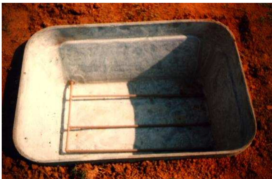
Figura 2 – Lisímetro equipado com tubos perfurados.
