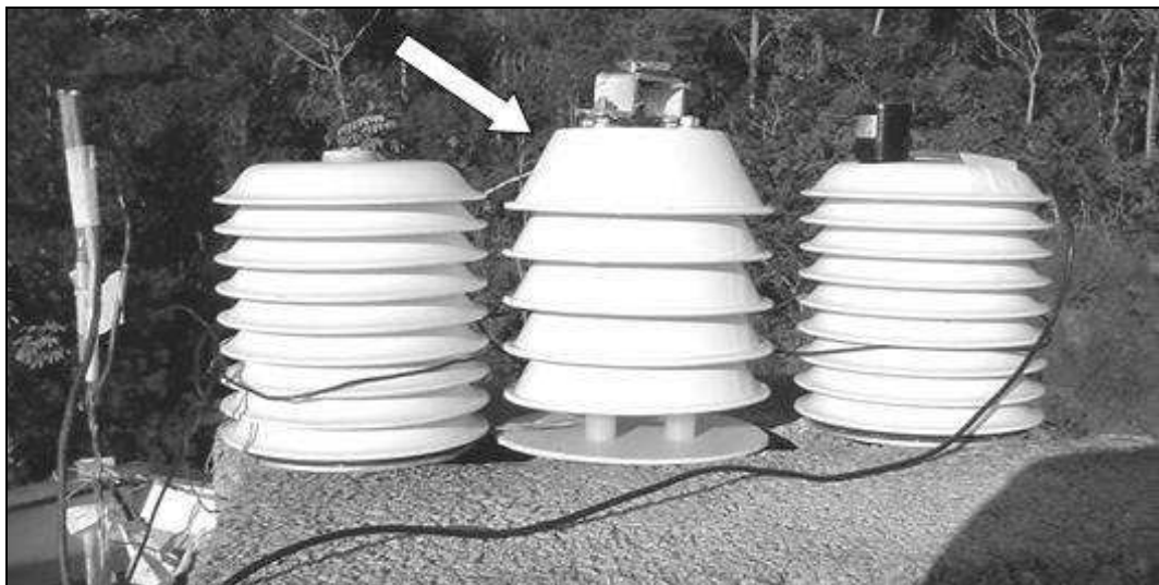
Figura 17 – Abrigo de sensores padrão e teste utilizado para a coleta dos dados de temperatura, umidade relativa e radiação solar em campo.
