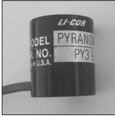
Figura 6 – Piranômetro considerado padrão; Li-200SA, LiCor
