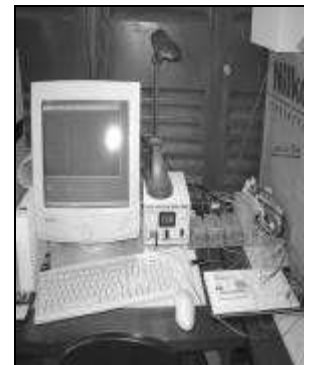
Figura 7 – Sistema de aquisição de dados com comunicação serial e o microcomputador, utilizados para a aquisição e armazenamento de dados com o algoritmo de linguagem “C”.
