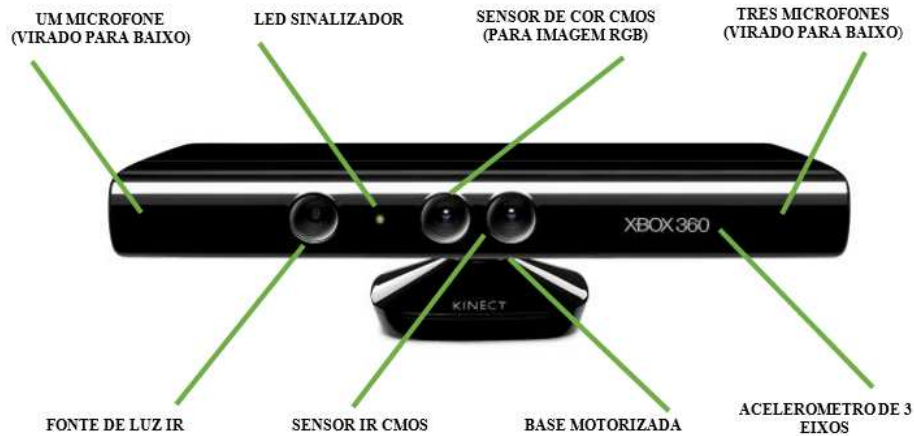
Figura 1: Sensor de movimento Kinect e suas partes constituintes
