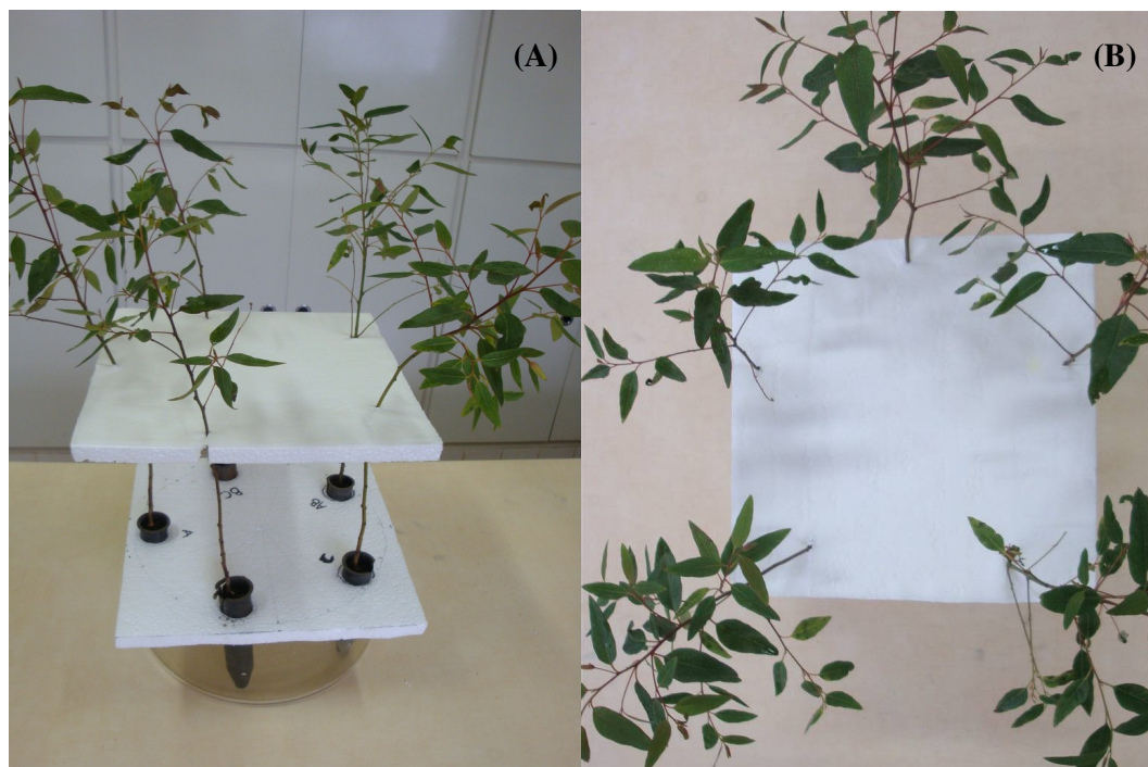
Figura 1. Arena utilizada para o teste de livre escolha com lagartas: (A) Vista lateral e (B) Vista superior.
